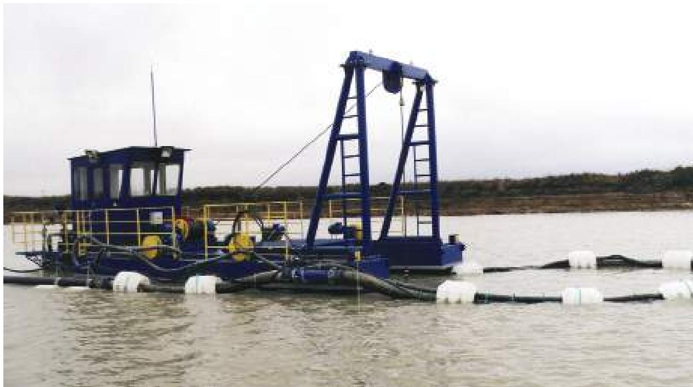
Несамостоятельный землесосный снаряд предназначен для дноуглубительных работ, очистки водоемов, добычи нерудных материалов со дна акватории, намыва территории, добычи песка.
