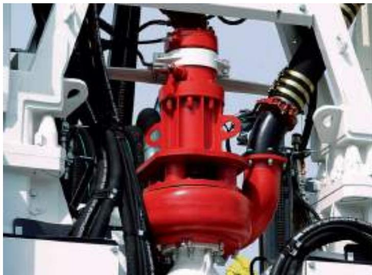
**Специальное исполнение "Haber mann" - "KBKT-V1" с гидравлическим приводом, оснащающий траншекопатели ведущих европейских специализированных производителей**
