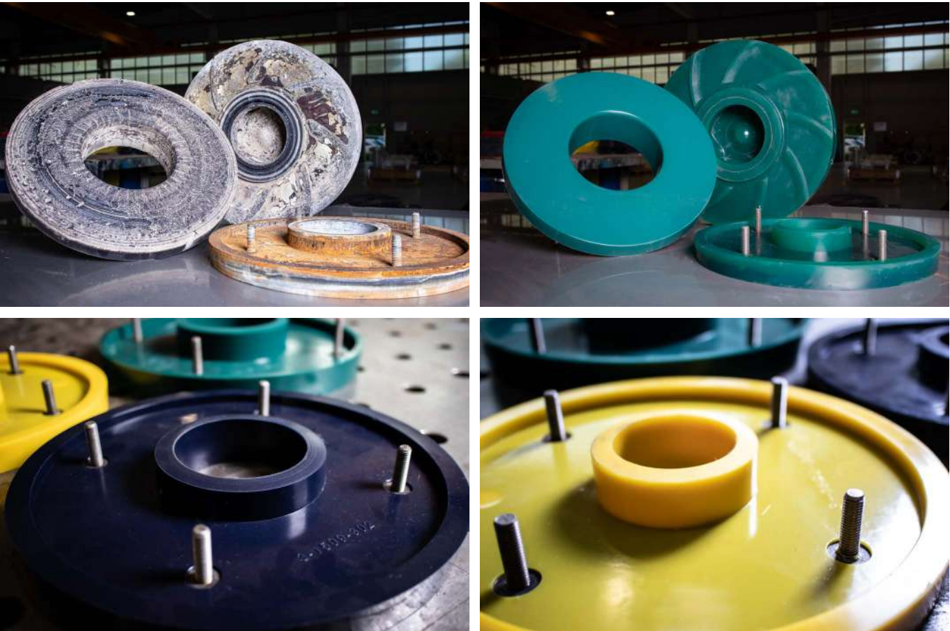
Серия НРК включает одноступенчатые центробежные насосы с защитным покрытием проточной части и регулируемым зазором со стороны всасывания.
